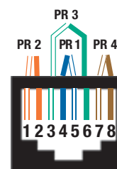
EIA/TIA568B AT&T 258A WIRING
